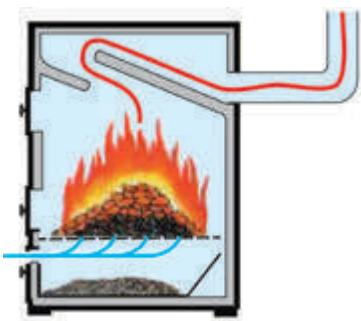
**Мал. 6.** Піч із нижньою подачею повітря. За рахунок такої конструкції температура полум'я стає значно вищою і дозволяє виплавляти метали та випікати кераміку
