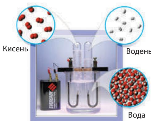
**Мал. 96.** Прилад для добування кисню електролізом води
