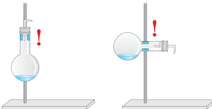
**Мал. 28.** Закріплену колбу можна орієнтувати по-різновому, обертаючи затискач у муфті
