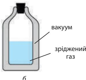
теплоту, і в ній тривалий час при низькій температурі може зберігатися зріджений газ.
