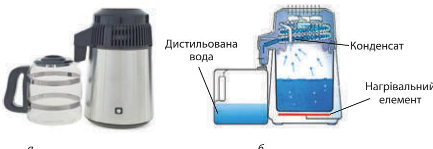
**Мал. 118.** Дистиллятор — пристрій для повного очищення води: а — зовнішній вигляд; б — внутрішня будова. Він являє собою бак із нагрівальним приладом. Вода в баку постійно кипить, а водяна пара конденсується в спеціальній ємності — приймачі
