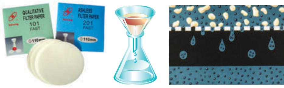
**Мал. 45.** Для розділення сумішей фільтруванням використовують фільтрувальний папір (а), крізь який пропускають неоднорідну суміш із водою (б). При цьому велики частинки, розмір яких більший за пори фільтра, затримуються, а вода й дрібніші частинки просочуються (в)
