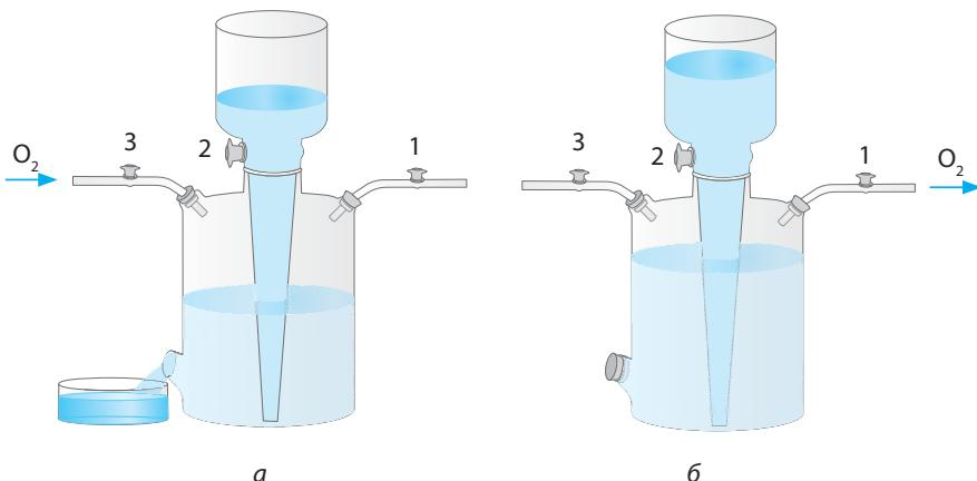
**Мал. 98.** Газометр для зберігання і використання газів у лабораторії: а — наповнення газометру киснем методом витіснення води (крані 1 і 2 закриті, кран 3 відкритий); б — використання зібраного кисню (крані 1 і 2 відкриті, кран 3 закритий)
