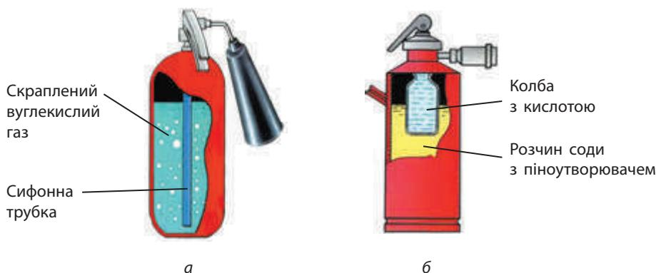
**Мал. 108.** Вогнегасники: а — вуглексілотний; б — кислотний
