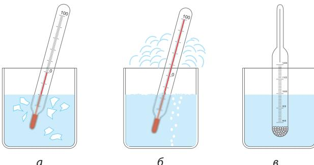
**Мал. 33.** Фізичні властивості води: а — замерзає при  $0\text{ }^{\circ}\text{C}$ ; б — кипить при  $100\text{ }^{\circ}\text{C}$ , температуру замерзання і кипіння можна вимірюти термометром; в — вода має густину  $1000\text{ kg/m}^3$ , її можна вимірюти ареометром
