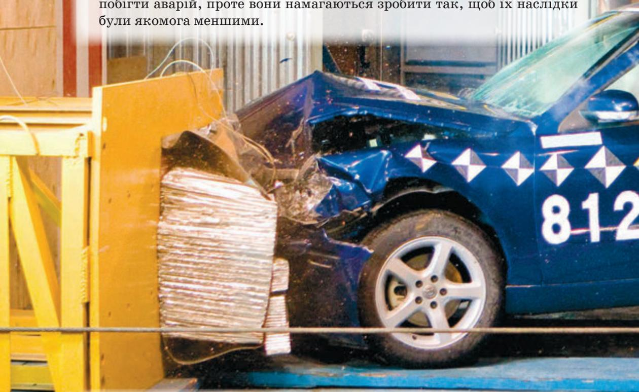
Для цього автомобілі конструюють таким чином, щоб деформації зазнавала тільки його передня (задня) частина, а салон був якнайкраще захищений від зминання. Перевірку своїх ідей інженери здійснюють за допомогою так званих *краш-тестів*. Для проведення такого тесту абсолютно новий автомобіль оснащують величезною кількістю датчиків, у салоні розміщують манекени, які теж мають датчики. Після цього автомобіль розганяють до швидкості 40–60 км/год і спрямовують на перешкоду.
