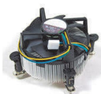
**Рис. 12.4.** Обертова частота кулерів сучасних процесорів становить 50–60 обертів за секунду
