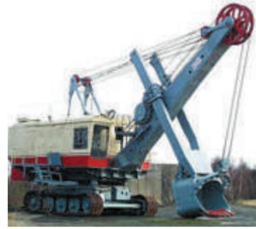
**Рис. 35.2.** Нерухомі блоки, які є в конструкції кар'єрних екскаваторів, дозволяють змінювати напрямок дії сил під будь-яким кутом
